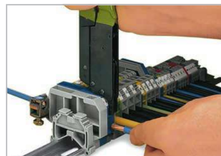
Установите клещи в верхнее рабочее отверстие клеммы с боковым вводом, затем установите зажим в боковое рабочее отверстие. Сожмите обе рукоятки до щелчка – отверстие клеммы полностью откроется. Вставьте зачищенный проводник до упора.
