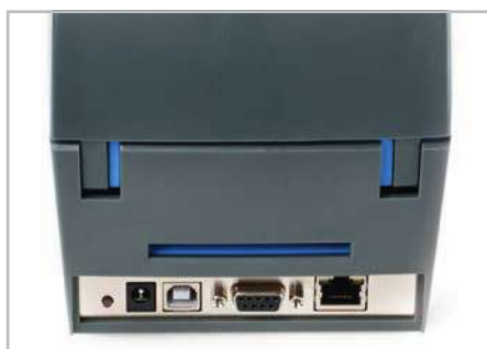
Принтер имеет несколько разъемов: USB, ETHERNET, последовательный COM-порт
