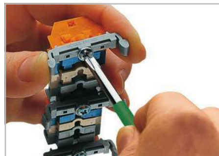
Фиксация монтажной ножки (209-123) к клеммной колодке с помощью монтажных фланцев (расстояние между монтажными ножками: примерно 35 ... 40 мм).
